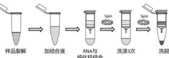
图 1. 离心柱式 RNA 抽提流程示意图
