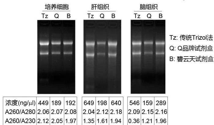
图 2. 本试剂盒与 Trizol、Q 品牌同类产品的 RNA 抽提效果对比。样品为冻存的 50 万个 HeLa 细胞、20mg 小鼠肝组织和 20mg 小鼠脑组织。洗脱液用量均为 40 $\mu$ l。均取 6 $\mu$ l 洗脱的样品经变性处理后，在含 6.67% 甲醛和适量 NA-Red 的 1.2% 变性琼脂糖凝胶中电泳约 45 分钟后拍照。实际抽提效果会因实验条件、检测仪器等的不同而存在差异，本图仅供参考。
